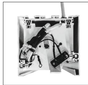
Elektrischer Anschluss mit zusätzlicher Mikroschalter
